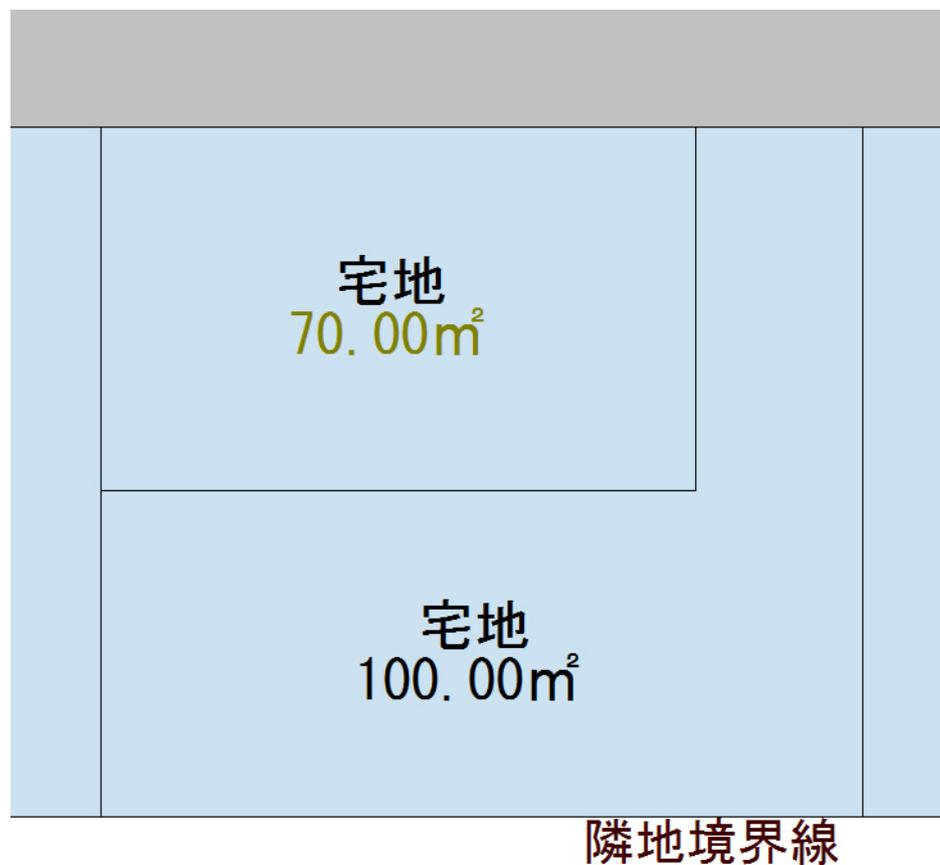
宅地部の70m<sup>2</sup>は、分割後69.99m<sup>2</sup>となった為、選択後右ボタンメニュー「プロパティ」から「面積地手入力」で直接入力する。
